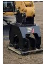
Plaque vibrante montée sur bras Pelle hydraulique
