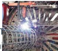
Semi-Automatique Machine soudage pieux fondation
