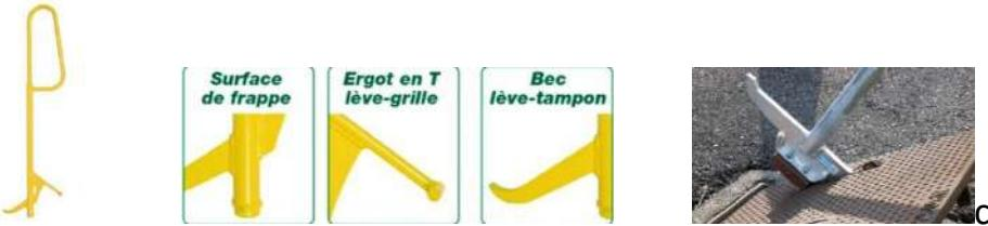
Il permet à l'opérateur de réaliser différentes actions : comme taper sur la plaque avec la surface de frappe pour décoller la grille ou la plaque d'égout, insérer l'outil dans l'encoche de la grille ou de la plaque, soulever la grille ou la plaque en faisant levier vers le haut, ou encore tirer la grille ou la plaque pour la dégager, en limitant fortement les contraintes au niveau de la région lombaire
