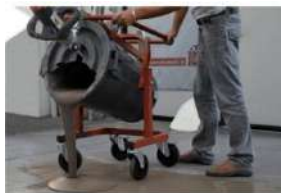
Seau inclinable pour ciment liquide
