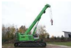
Grue mobile sur chenilles à flèche télescopique :
