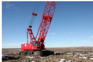
Grues mobiles sur chenilles à flèche treillis
