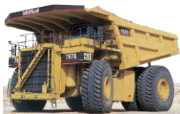
Tombereau rigide (Dumper) sur chantier autoroutier, carrière
