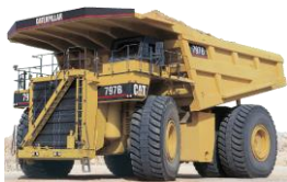
Tombereau rigide (Dumper) sur chantier autoroutier, carrière
