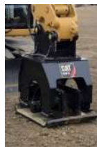
Plaque vibrante montée sur bras Pelle hydraulique
