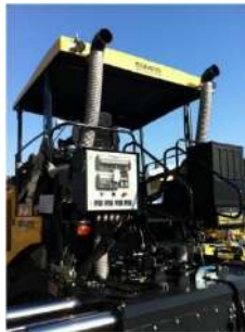
Système extraction des fumées table d'application
