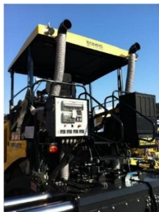
Système extraction des fumées table d'application
