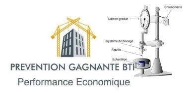
Les profondeurs de pénétration sont exprimées en dixièmes de millimètre. Le résultat permet de déterminer dans quelle classe se situe l'échantillon de bitume testé. Treize classes sont déterminées en Europe pour les bitumes routiers :
