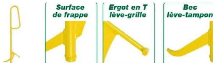
Il permet à l'opérateur de réaliser différentes actions : comme taper sur la plaque avec la surface de frappe pour décoller la grille ou la plaque d'égout, insérer l'outil dans l'encoche de la grille ou de la plaque, soulever la grille ou la plaque en faisant levier vers le haut, ou encore tirer la grille ou la plaque pour la dégager, en limitant fortement les contraintes au niveau de la région lombaire
