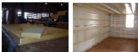
**Fabrique les planchers sur vide sanitaire** (si pas de dalle béton) : solives de section rectangulaire ou poutres en i, plafages en panneaux à base de bois, isolant, pare vapeur en sous face du panneau de plafage, panneau fond de caisson),
