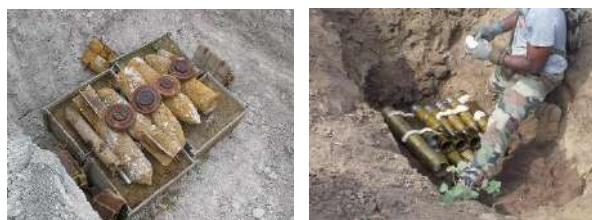
L'opérateur les empile et les recouvre de poudre d'amorçage.
