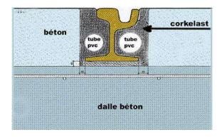
Ce type de pose présente un bon affaiblissement vibratoire (- 10 dB) et permet son installation entre 7m et 11m des habitations ; c'est une pose sur appui continu.
