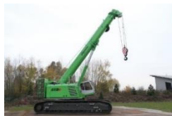
Grue mobile sur chenilles à flèche télescopique :
