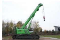
Grue mobile sur chenilles à flèche télescopique :
