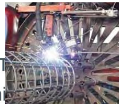
Semi-Automatique Machine soudage pieux fondation
